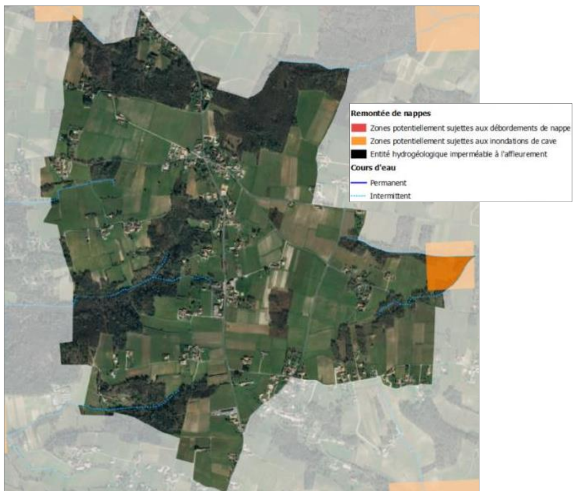
Aléa remontée de nappes sur Saint-Trojan (source : Géorisques)
